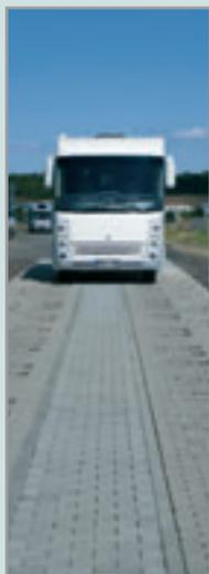
Nach Fertigstellung der Fahrzeuge durchläuft jedes Reisemobil die hauseigene Teststrecke und eine Beregnungshalle, bevor der Kunde es in Empfang nehmen kann. Dabei geht es für die Fahrzeuge auf anspruchsvolle Streckenabschnitte mit unterschiedlichen Fahrbahnbelägen, die die Sicherheit und das Fahrverhalten (Bremsen, Anzug, Laufruhe) von Fahrwerk und Aufbau prüfen. Diese Strecke ist wie folgt aufgebaut:
