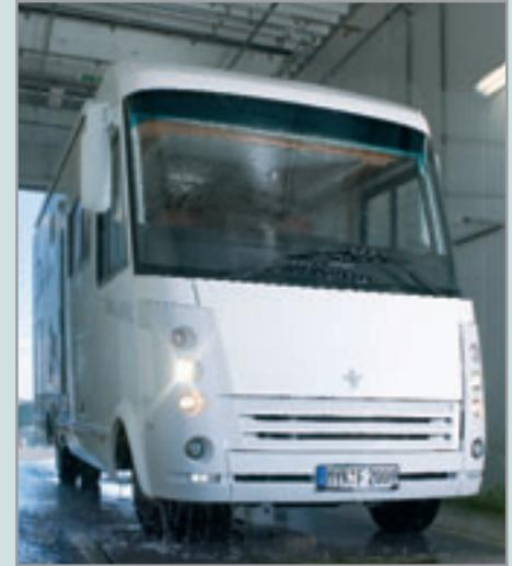
■ Auf einer Länge von ca. 120 m wird mit einer Durchfahrt eine Strecke von 20 km simuliert. Die Strecke verläuft über ein welliges Basalt-Kopfsteinpflaster („Belgischer Block“). Dann folgt ein Verbundsteinpflaster, in das zahlreiche quadratische, fünf Zentimeter tiefe Fahrbahnunebenheiten eingearbeitet sind. Sie sind so groß, dass die Reifen beim Durchfahren einsinken. Auf diese Weise lassen sich Schlaglöcher simulieren und auf ihre Auswirkungen prüfen.
