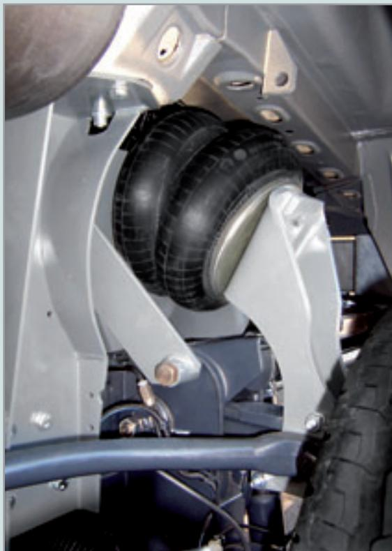
Aus der konstruktiven Zusammenarbeit der beiden Partner Goldschmitt und Niesmann+Bischoff entstand für den Flair eine Sensation: die weltweit erste Vorderachsluftfederung und damit erste Vollluftfederung für den Iveco-Daily. Diese Lösung ermöglicht eine komfortablere Federabstimmung und beschert dem Flair einen konkurrenzlosen Fahrkomfort.
