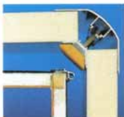
Der 50 mm starke Alu-Sandwich-Aufbau im Vergleich zu herkömmlicher Bauweise.
