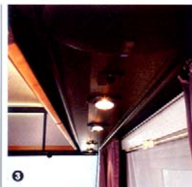
3: Exclusives Alu-Oberschrankprofil mit integrierten Leitungskanälen, Lautsprechern, Lampen und Vorhangschienen
